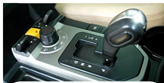
Dźwignia skrzyni i pokrętko sterują- ce Terrain Response
