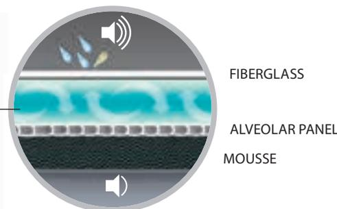
Le revêtement intérieur du toit avec double paroi est une exclusivité Autohome. Le coussin d'air obtenu grâce au panneau alvéolaire interne et la mousse anticondensation contribuent à obtenir une meilleure isolation thermique et acoustique et un environnement plus sain et plus silencieux en cas de pluie.
