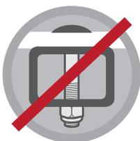
Ne pas trouser les barres de la galerie pour fixer la tente. Opération actuellement non consentie par les normes de sécurité. Il est interdit de modifier la galerie.
