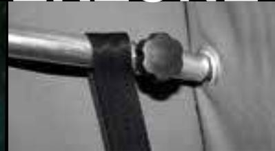
Zwei Bänder wurden in die Struktur integriert. Sie fixieren den Eingang vor dem Einstieg ins Zelt, damit kein "Segel Effekt" (Aufschlagen bzw. Flattern des Stoffes) entsteht.
