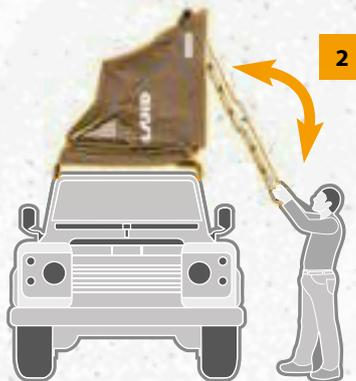
Die Leiter an der Basisplatte ermöglicht eine schnelle und problemlose Öffnung des Zeltes.
