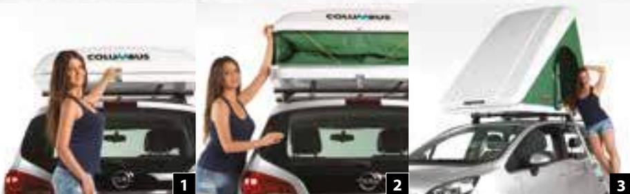
Die Columbus Serie ist mit einer sich selbst öffnenden Gasfeder-Automatik ausgestattet. Nach Öffnen des hinteren Verschlusses wird die obere Dachschale durch die beiden Gasfedern aufrichtet und der Zeltstoff straff gespannt.
