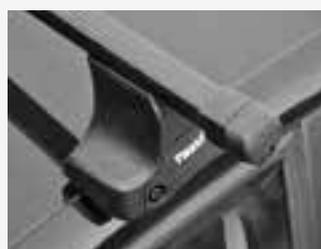
Esempio di attacco portatutto per autovetture con tetto liscio (senza grondine).
