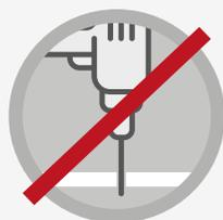
Per il fissaggio sulle barre portatutto non devono essere forate le basi delle tende.
