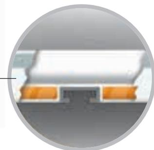
La base realizzata a "sandwich", offre un isolamento di 25 mm di spessore, mentre le 2 guide a "C" permettono un facile aggancio a qualsiasi portatutto (senza effettuare nessun intervento) rendendo stabile e sicura la struttura, per resistere alle sollecitazioni "off-road".
