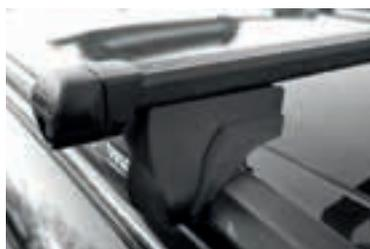
Barre di giunzione per autovetture con railing.
