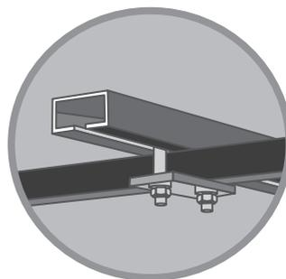
Le guide a "C" e i relativi morsetti consentono un rapido montaggio, permettendo di personalizzare la disposizione sul tetto dell'auto, evitando qualunque tipo di foratura. Qualità e sicurezza certificata TÜV.
