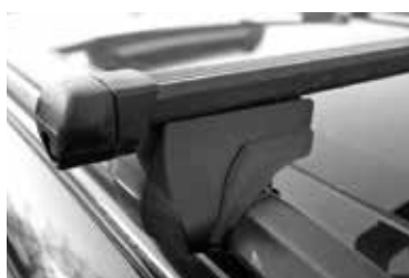
Barres transversales pour voitures avec railings.
