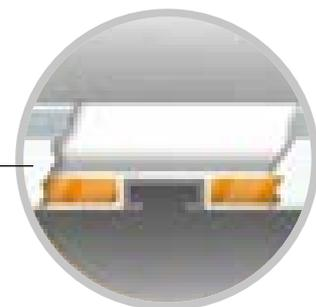
Der "Sandwich"-Boden besitzt eine 25mm Isolierung. Die beiden eingebauten "C"-Profil Schienen ermöglichen die einfache und zuverlässige Klemm-Montage auf handelsüblichen Gepäckträgern mit 20x30 mm Mindestprofil-Querschnitt.
