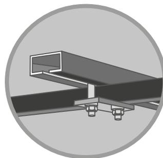
Die C-Profile und die passenden Klammern ermöglichen eine rasche Montage sowie eine individuelle Anpassung der Lage des Zeltes auf dem Autodach. Bohrungen an den Trägerstangen oder am Rahmen sind nicht nötig. TÜV zertifizierte Qualität und Sicherheit.
