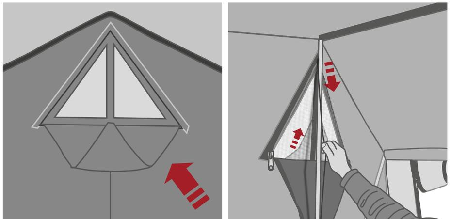
Jedes Fenster hat einen doppelten Verschluss und besitzt zur Abdunkelung ein lichtschützendes System im Außen- und Innenzelt. Alles ist leicht durch ein einfaches Seil steuerbar, dieses genau wie unsere Hausrolläden, jede Lichtenpassung in bequemer und liegender Position steuern lässt. Ebenso müssen sie nicht das Zelt verlassen, um das Fenster vollständig zu schließen.
