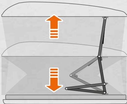
Das System ist durch vier zuverlässige Gasfedern gekennzeichnet, die ein schnelles und präzises Öffnen auslösen. Die vier Stützarme brauchen nicht einmal manuell ausgefahren werden, wie es bei herkömmlichen Systemen der Fall ist.
