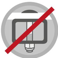
Ne pas trouser les barres de toit pour fixer la tente. Opération actuellement non consentie par les normes de sécurité. Il est interdit de modifier les barres.
