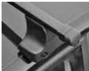
Exemple de barres de fixation pour voitures avec toit sans gouttières.
