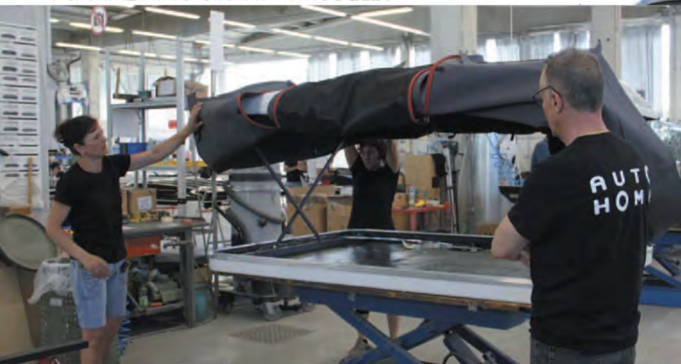
L'assemblage des tentes est manuel sur les coques en fibre de verre qui viennent du moulage.
