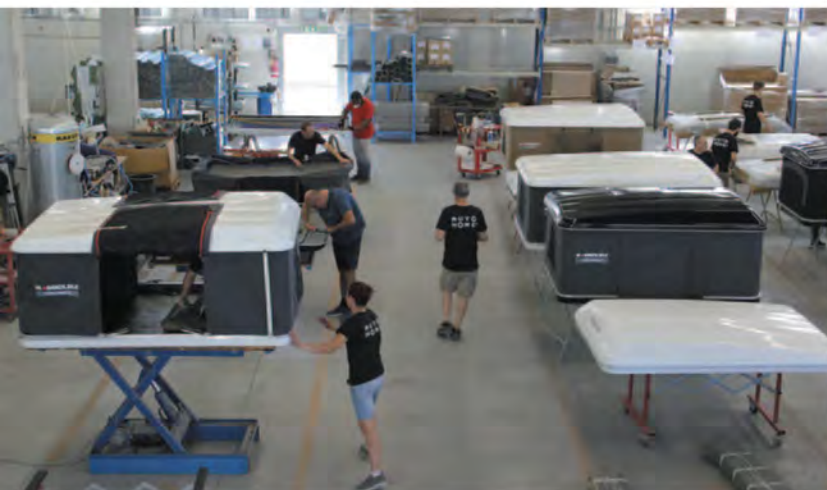
L'assemblage des tentes est manuel sur les coques en fibre de verre qui viennent du moulage.
