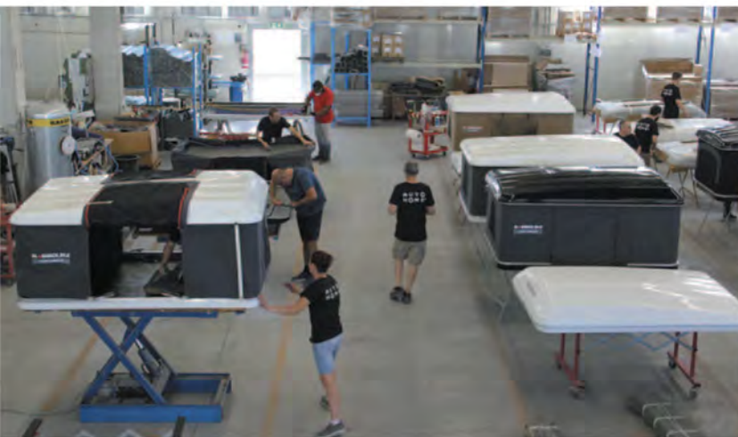
L'assemblaggio delle tende è eseguito manualmente sui gusci di fibra di vetro che arrivano dallo stampaggio.
