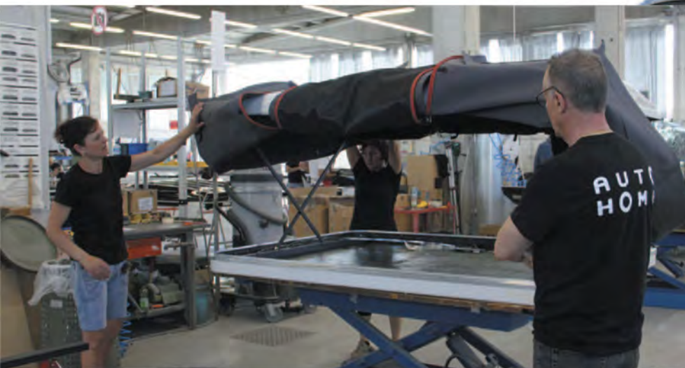
L'assemblaggio delle tende è eseguito manualmente sui gusci di fibra di vetro che arrivano dallo stampaggio.
